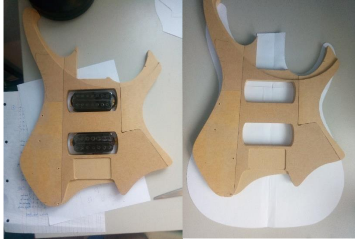
Figure 38: Résultat de l'usinage du médium
