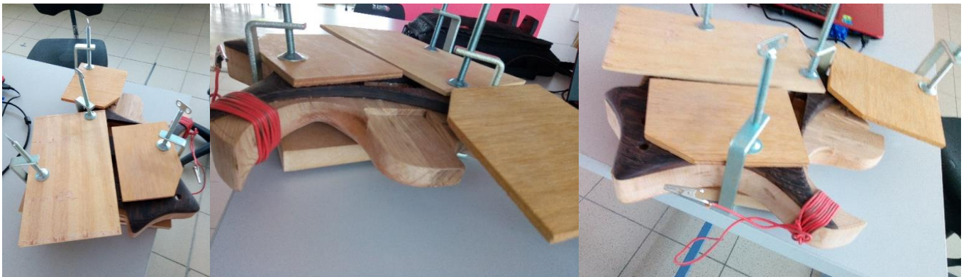
Figure 45 collage de la table avec le bloc de freine pour constituer le corps
